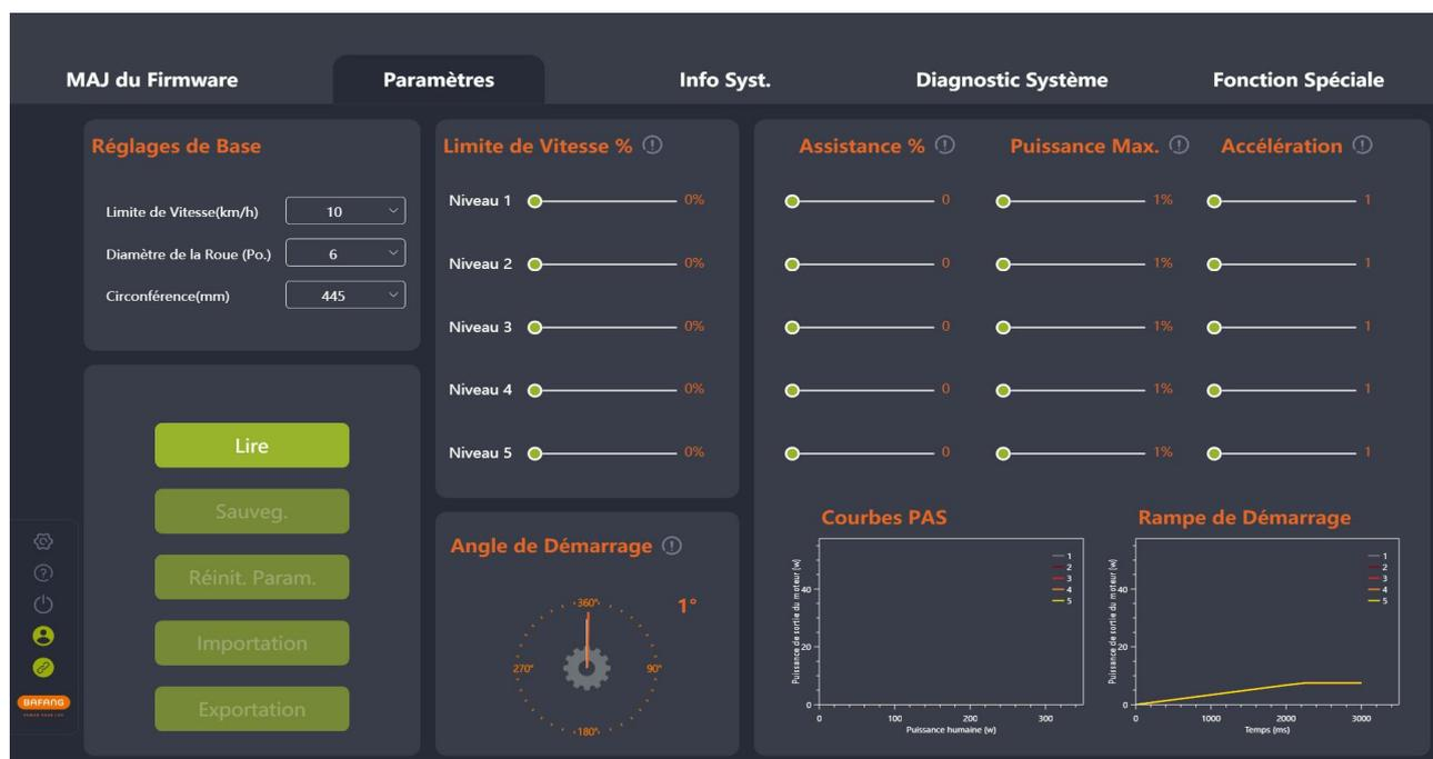
Fig. 5-2 Paramètres du produit interactif
